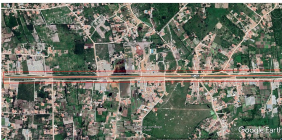
Figura 9: Propriedades que invadem a faixa de domínio no trecho em análise.
